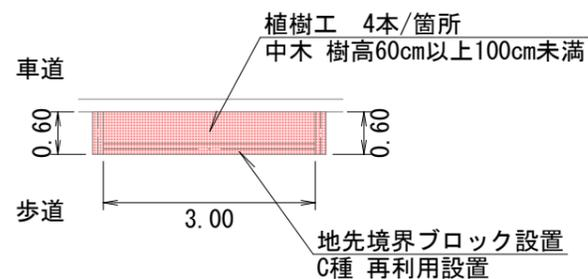
舗装工構成図 S=1/20
