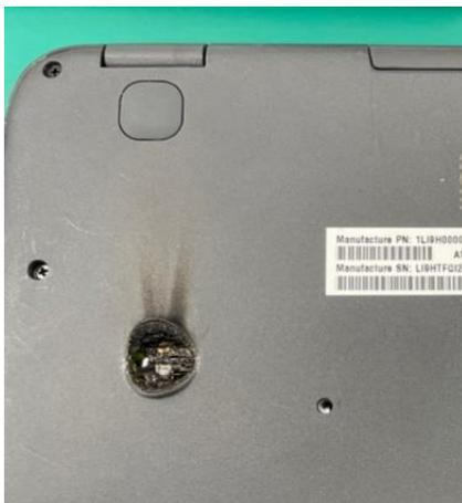
※水没後に端末を起動したことにより内部で発火した可能性があり、裏面に穴が開いています。
